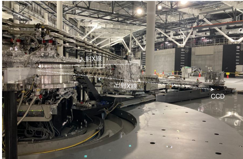
図 2. NanoTerasu 共用ビームライン BL02U の共鳴非弾性 X 線散乱装置 (2D-RIXS)。入射 X 線はビームラインを通して試料に照射される。試料で散乱された出射 X 線を分光し、スペクトルを CCD で観測する。
