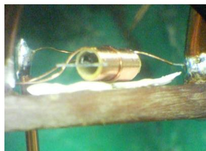
図5 試料を NMR 用コイルにセットした様子。コイルの直径は 1mm 程度。
