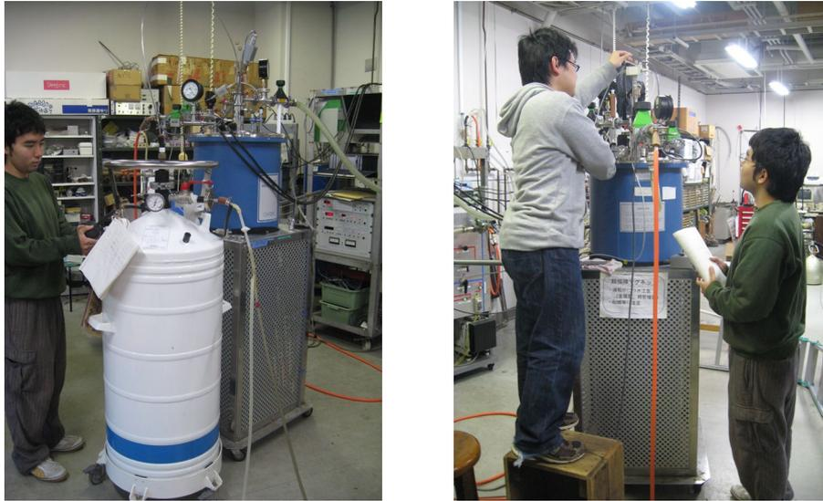
図6 本学最大級の強磁場発生装置(15-17 T 超伝導磁石)を用いた NMR 測定. 左図: 15-17 T 用冷凍機にヘリウムを移送している様子. 右図: NMR プロブの調整をしながら実験を行っている様子. 写真は西山君と鯨井君.
