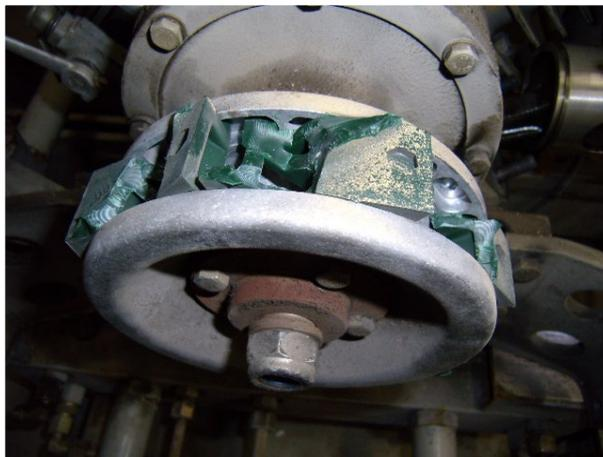
冷却ファンの羽が全て折れ脱落している
