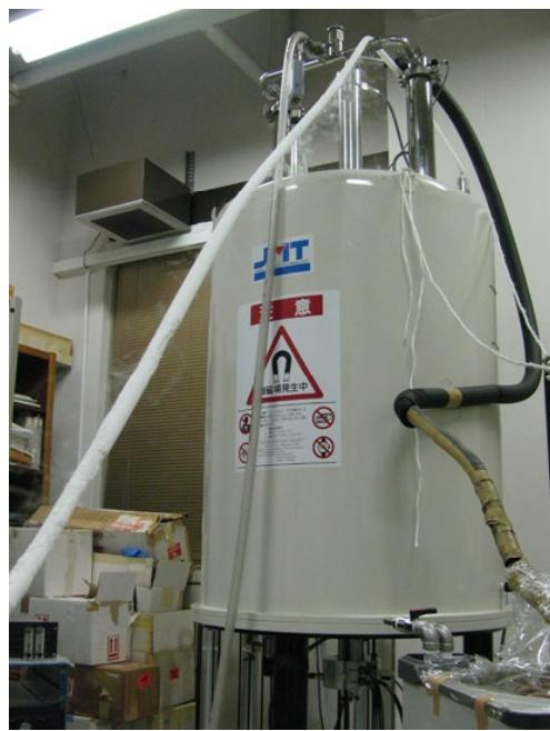
図2 NMR 分光器の 400 MHz 超伝導磁石
