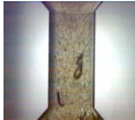
高速度カメラでとらえた気泡の変形
